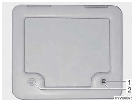
Bilde 149 Klaff for kloakktanken
