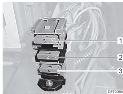
Kuva 104 Sähkö- ja elektroniikkayksikön vieressä olevat sulakkeet
