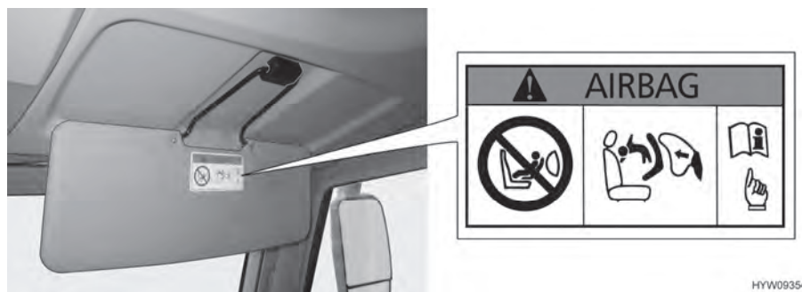
Kuva 10 Lasten turvalaitteisiin liittyvä varoitus (apuohjaajan häikäisysuoja)
