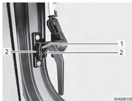
Kuva 40 Lukitusvipu, sivulla (asennossa "jatkuva tuuletus")
