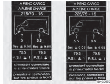
Kuva 164 Rengaspainetta koskeva ohjetarra B-pylväässä (esimerkki)
