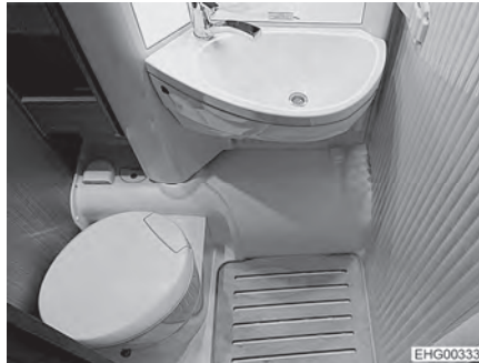
Kuva 143 WC-istuin, käännetty seinää päin
