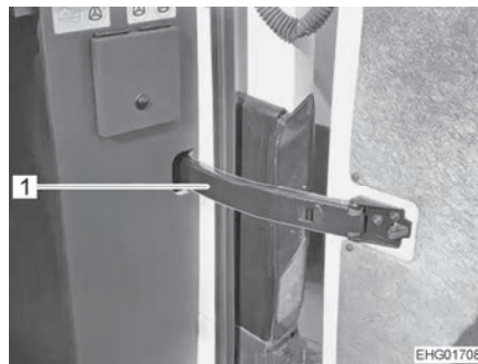
Afb. 27 Beperking van de openingshoek (Basisvoertuig VW)
