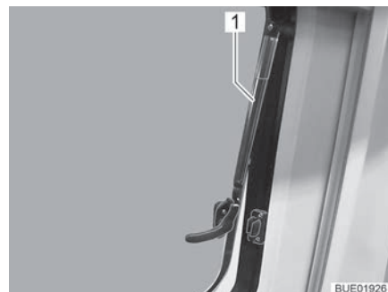
Afb. 30 Uitzetbaar raam met automatische uitzetters, geopend
