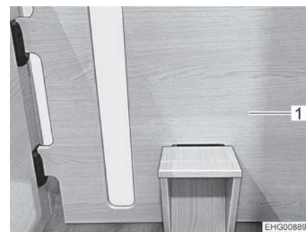
Afb. 66 Tussenwand met trapelement
