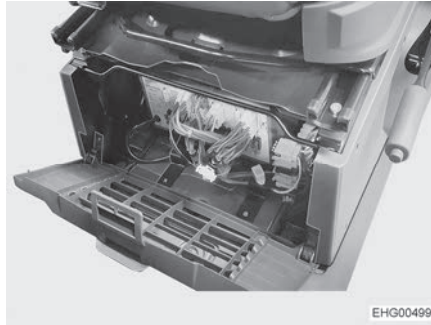
Afb. 102 Inbouwplaats elektroblok (Stellantis), afb. ter indicatie
