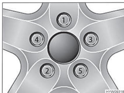
Afb. 167 Wielmoeren of wielschroeven kruisgewijs vastdraaien
