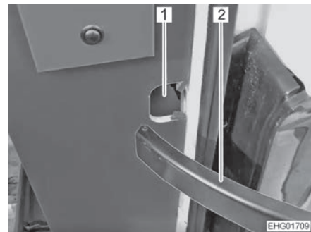
Afb. 28 Beperking van de openingshoek, opgeheven (Basisvoertuig VW)
