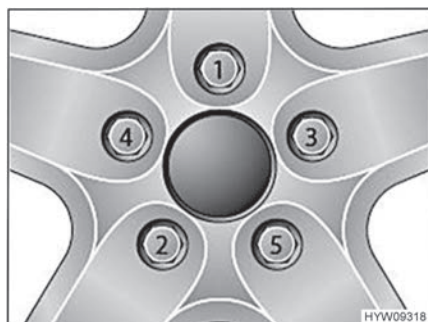
Kuva 167 Kiristä pyörien mutterit tai pultit ristiin
