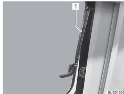
Kuva 30 Avattavat ikkunat, joissa on automaattipidikkeet, avattu
