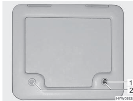
Bild 83 Lucka för latrintanken
