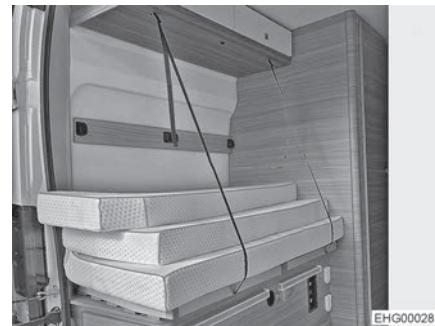
Bild 36 Transportläge (avtagbar sängbotten)
