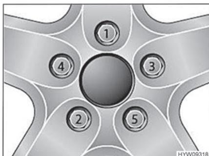
Fig. 88 Serrer en croix les écrous ou les boulons de roue
