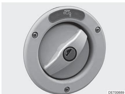
Fig. 70 Couvercle de fermeture pour bec de remplissage d'eau potable
