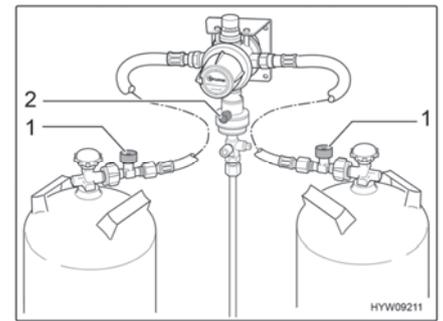
Fig. 6 Régulateur de gaz (DuoControl)
