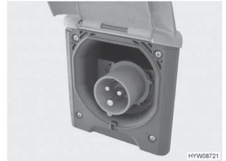
Fig. 52 Collegamento a 230 V al veicolo (presa CEE)
