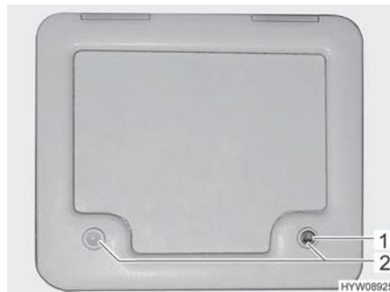
Fig. 83 Sportello per il serbatoio fecale
