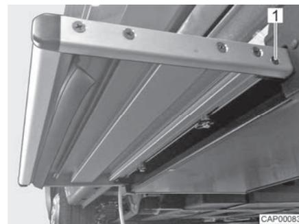
Fig. 86 Arresto (scalino di ingresso)
