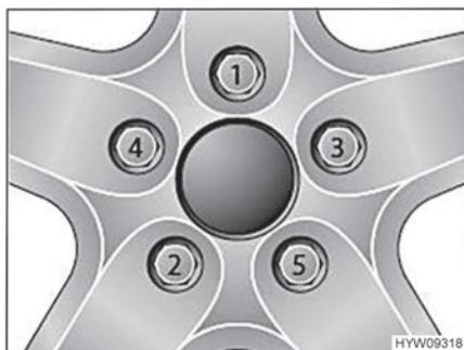
Fig. 88 Serraggio a croce di dadi delle ruote e bulloni delle ruote
