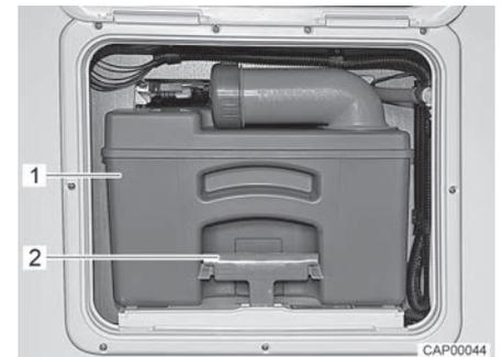
Fig. 84 Serbatoio fecale
