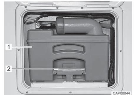
Fig. 84 Depósito de aguas fecales
