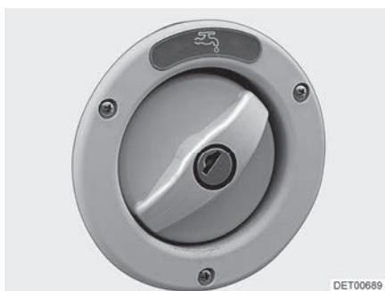
Fig. 70 Tapa de cierre para el tubo de llenado de agua potable
