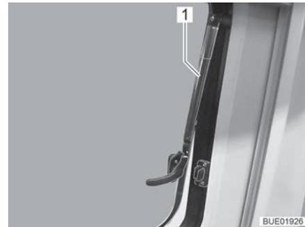
Fig. 11 Ventana abatible con soportes automáticos, abierta
