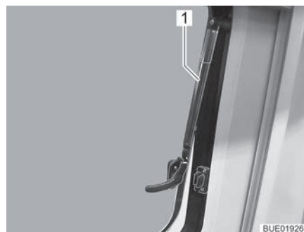
Afb. 11 Uitzetbaar raam met automatische uitzetters, geopend
