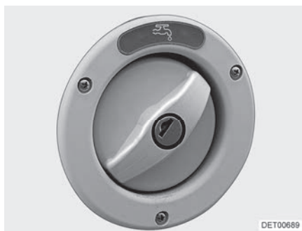
Kuva 70 Juomavesisäiliön täyttöaukon korkki
