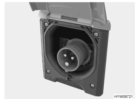
Bild 67 230-V-Anschluss am Fahrzeug (CEE-Steckdose)
