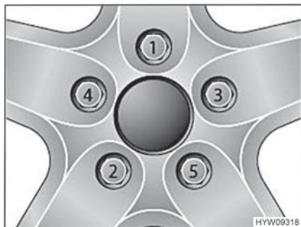
Afb. 112 Wielmoeren of wielschroeven kruisgewijs vastdraaien
