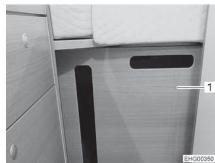
Afb. 34 Tussenwand met trapelement
