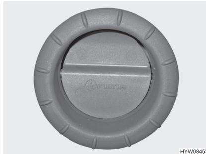
Bild 58 Luftaustrittsdüse (Warmluft-Heizung)
