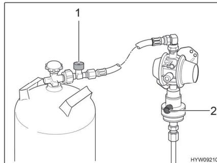
Bild 5 Gasregler (MonoControl)
