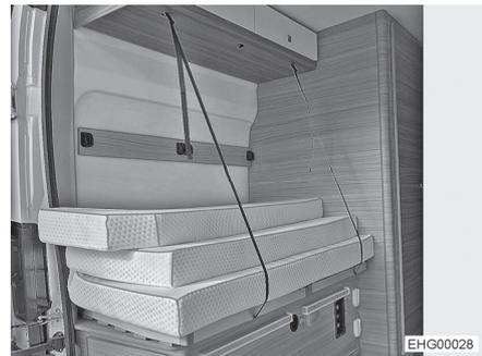
Bild 36 Transportstellung (herausnehmbarer Bettrost)
