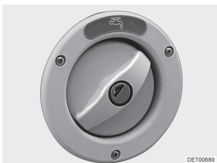
Bild 70 Verschlussdeckel für Trinkwasser-Einfüllstutzen
