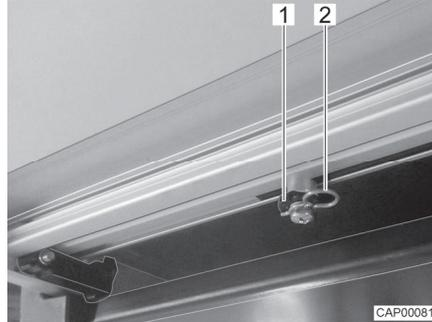
Bild 2 Antriebsstange (Eintrittstufe)
