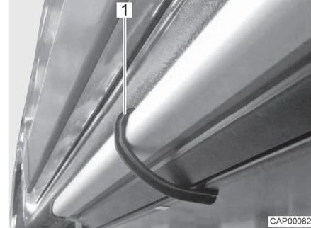
Bild 3 Halteklammer (Eintrittstufe)
