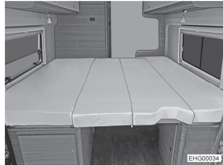
Bild 34 Nach dem Umbau (Variante mit 4 Polstern)
