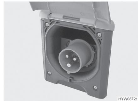
Bild 52 230-V-Anschluss am Fahrzeug (CEE-Steckdose)
