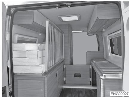
Bild 35 Transportstellung (klappbarer Bettrost)
