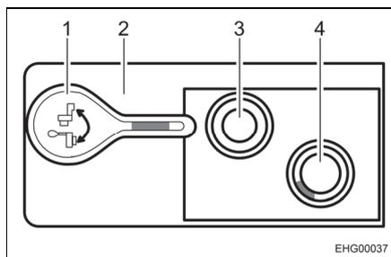
Bild 63 Ablassventil, geschlossen
