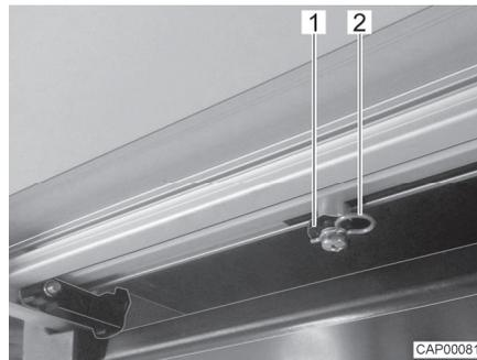
Bild 85 Antriebsstange (Eintrittstufe)
