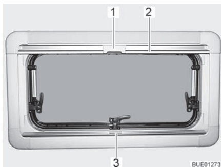
Bilde 33 Vindu med åpning utover
