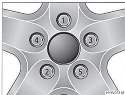
Bilde 167 Trekk til hjulmutrene eller hjulskruene over krysset
