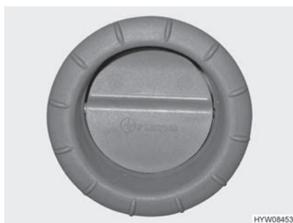
Bilde 120 Luftdyse (varmlufts-varmeanlegg)
