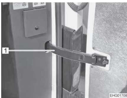
Bilde 27 Begrensning av åpningsvinkel (basiskjøretøy VW)
