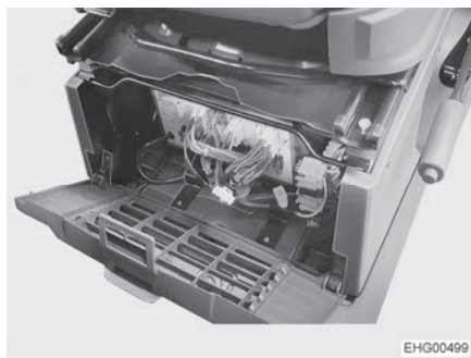
Bilde 102 Monteringssted for strømsentral (Stellantis), fig. lignende
