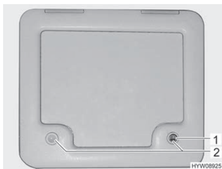
Fig. 210 Trampilla para el depósito de aguas fecales
