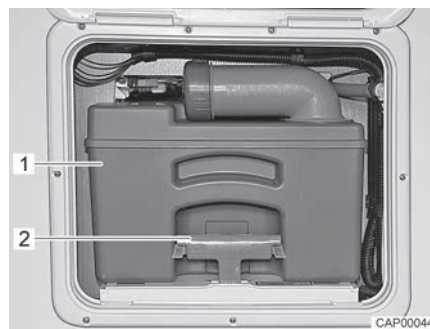
Fig. 211 Depósito de aguas fecales
