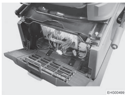
Fig. 151 Lugar de instalación del bloque eléctrico (Stellantis), fig. similar
