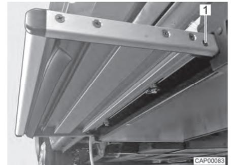
Fig. 120 Arresto (scalino di ingresso)
