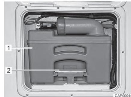
Fig. 118 Serbatoio fecale
