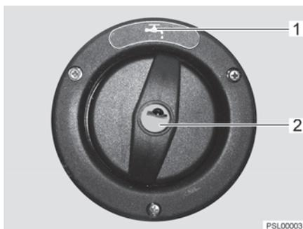
Fig. 104 Coperchio per bocchettone di riempimento dell'acqua potabile
