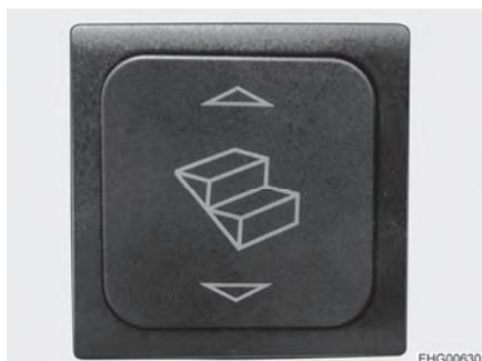
Fig. 3 Interruttore a bilico scalino di ingresso
