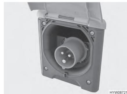
Fig. 79 Collegamento a 230 V al veicolo (presa CEE)
