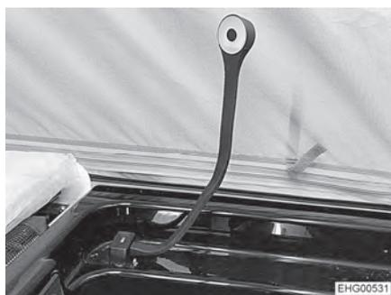
Fig. 63 Lampada a collo di cigno, posizione d'uso
