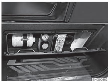
Fig. 126 Dotazione attrezzi (veicolo di base Ford)
