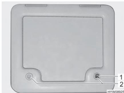
Fig. 117 Sportello per il serbatoio fecale
