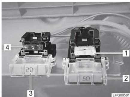
Fig. 84 Fusibili sulla batteria dell'abitacolo con booster di ricarica
