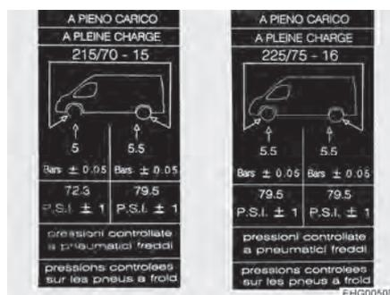
Fig. 129 Etichetta di avvertenza pressione degli pneumatici applicato su montante B (esempio)
