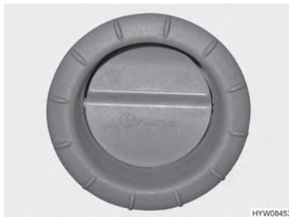
Fig. 92 Bocchetta di uscita dell'aria (riscaldamento ad aria calda)
