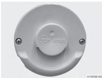
Bilde 96 Veggpipen (varmlufts-varme-anlegg)
