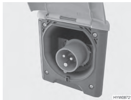
Bilde 79 230 V-tilkobling til kjøretøyet (CEE-stikkontakt)
