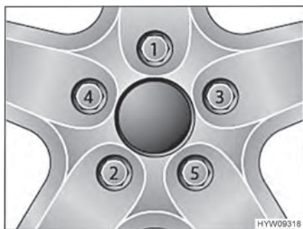
Bilde 127 Trekk til hjulmutrene eller hjulskruene over krysset
