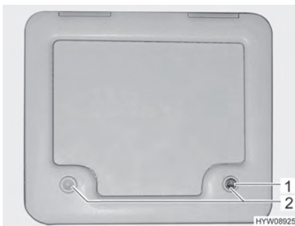
Bilde 117 Klaff for kloakktanken
