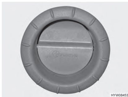
Bilde 92 Luftdyse (varmlufts-varmeanlegget)
