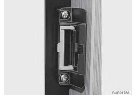
Fig. 102 Dispositif de fermeture en position de ventilation
