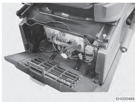
Fig. 74 Emplacement bloc électrique (Fiat/Citroën)
