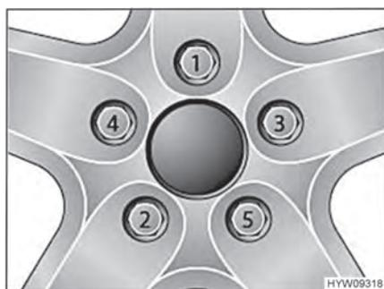
Fig. 127 Serrer en croix les écrous ou les boulons de roue
