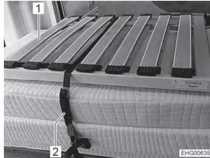
Fig. 39 Lit arrière (position de transport)
