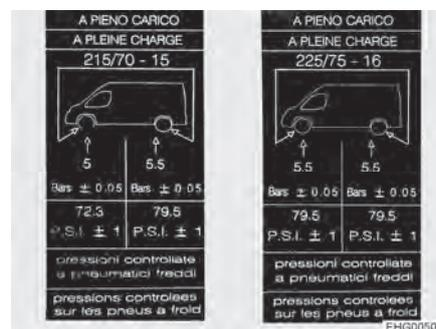
Fig. 129 Autocollant d'indication de la pression des pneus sur le montant B (exemple)
