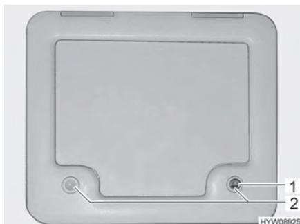
Fig. 117 Portillon pour le réservoir pour matières fécales
