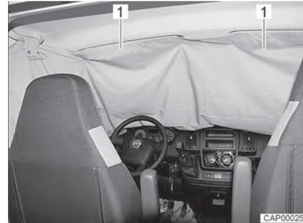
Fig. 24 Dispositif occultant de la cabine de conduite sur le pare-brise
