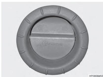
Fig. 92 Buse de sortie d'air (chauffage à air chaud)
