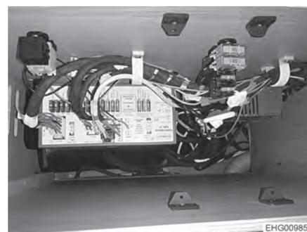
Fig. 75 Emplacement bloc électrique (Ford)
