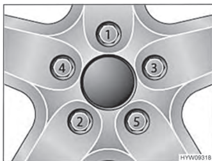
Bilde 94 Trekk til hjulmutrene eller hjulskruene over krysset
