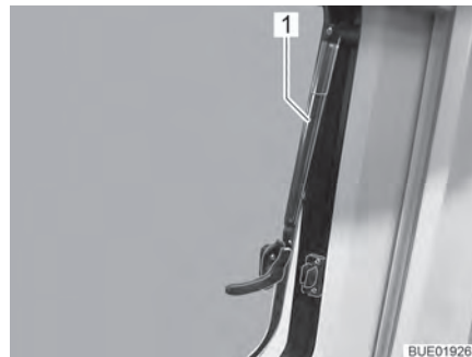
Bilde 13 Vindu som kan åpnes utover med armer med automatisk låsing, åpent
