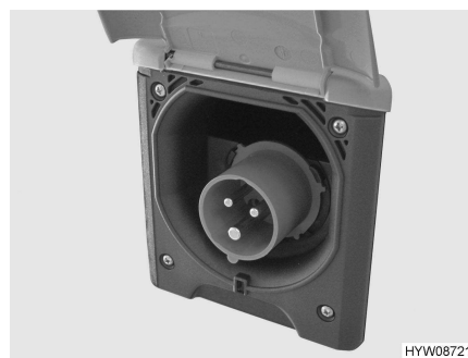
Bild 71 230 V-anslutning på fordonet (CEE-uttag)
