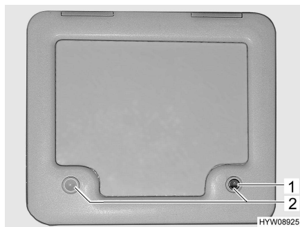
Bild 113 Lucka för latrintanken
