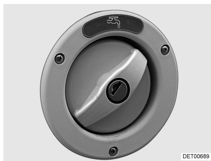
Fig. 96 Tapa de cierre para el tubo de llenado de agua potable
