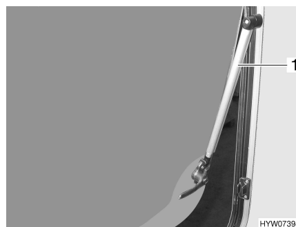
Fig. 22 Ventana abatible con soporte automático
