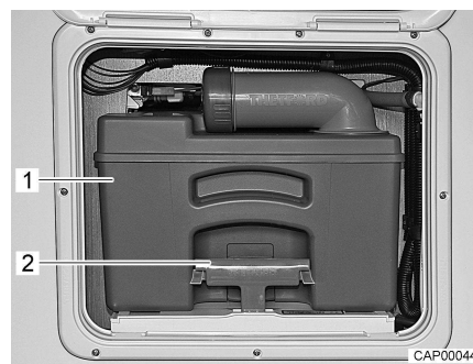
Fig. 114 Depósito de aguas fecales
