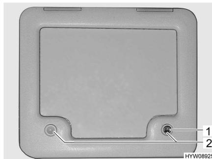
Bild 113 Klappe für den Fäkalientank
