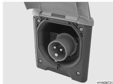
Bild 71 230-V-Anschluss am Fahrzeug (CEE-Steckdose)
