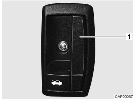
Bild 5 Entriegelungshebel (Motorhaube)
