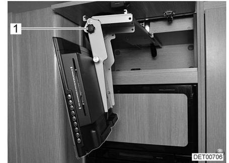
Bild 44 Flachbildschirm in Fernsehstellung
