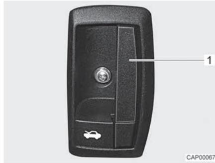
Fig. 6 Leva di sbloccaggio (cofano motore)
