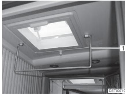
Fig. 119 Appendiabiti per asciugatura della biancheria
