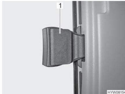
Fig. 28 Finestra scorrevole senza bloccaggio
