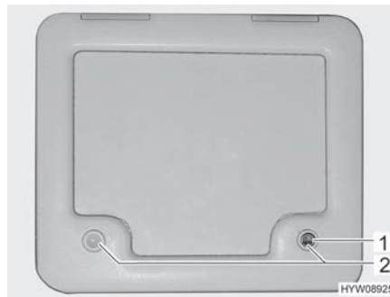
Bilde 125 Klaff for kloakktanken
