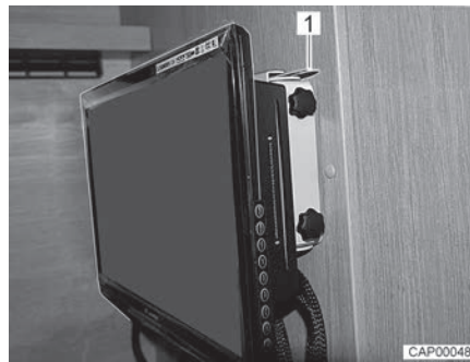
Bilde 55 Flatskjerm i kjøreposisjon
