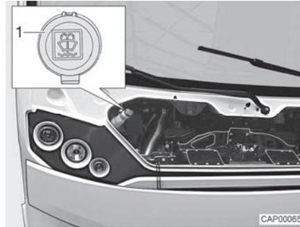
Bild 8 Einfüllstutzen (Scheibenwaschwasser)
