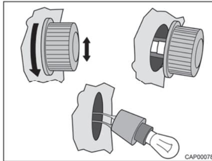
Bild 132 Seitlicher Fahrtrichtungsanzeiger (12 V/5 W)
