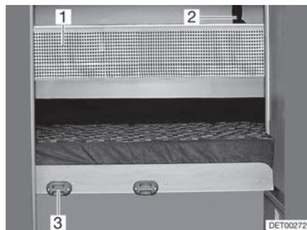
Bild 65 Sicherungsnetz
