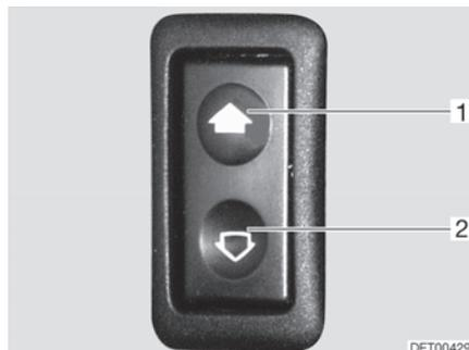
Bild 18 Schalter für elektrische Fensterheber
