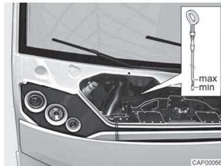
Bild 9 Ölmesstab (Motoröl)
