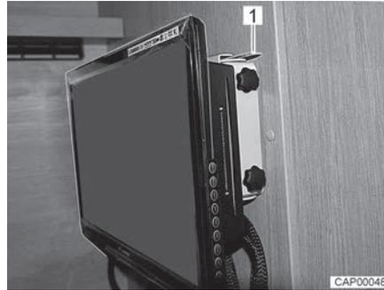
Bild 55 Flachbildschirm in Fahrtposition
