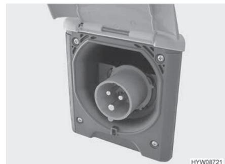
Bild 83 230-V-Anschluss am Fahrzeug (CEE-Steckdose)
