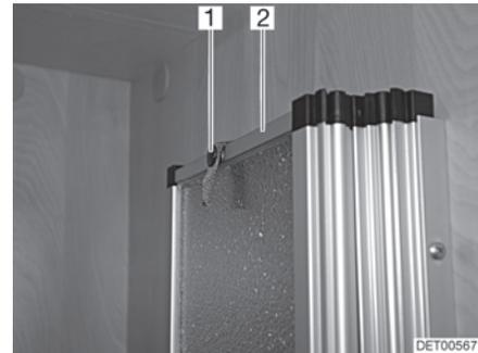
Bild 122 Befestigung, Duschtrennwand
