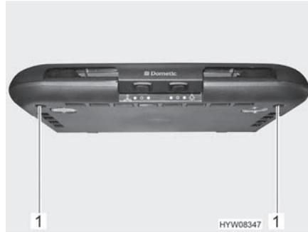
Fig. 127 Desmontar la cubierta inferior
