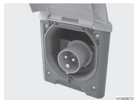
Fig. 83 Conexión de 230 V en el vehículo (caja de enchufe CEE)
