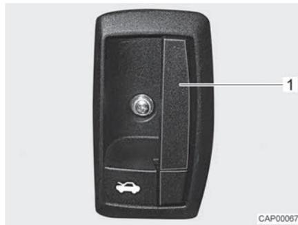
Fig. 6 Palanca de desbloqueo (capó del motor)
