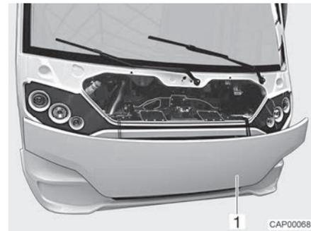
Fig. 7 Capó del motor
