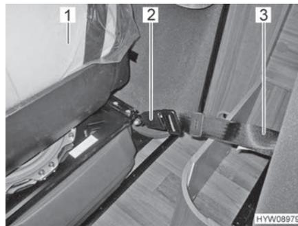
Fig. 15 Retener el asiento de enchufe con hebilla
