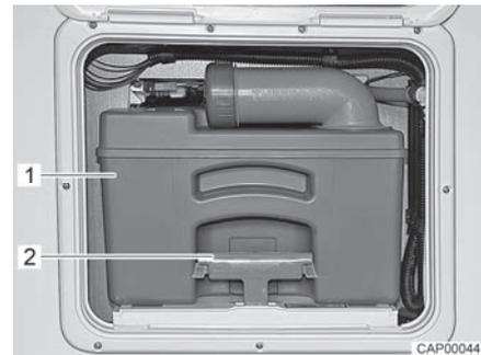
Fig. 126 Depósito de aguas fecales
