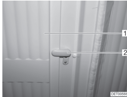
Kuva 121 Salpaus, WC-tilan verhous
