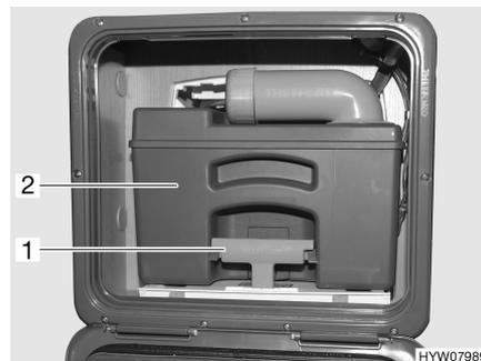
Fig. 81 Serbatoio fecale
