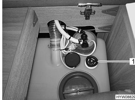
Fig. 72 Maniglia girevole per scarico acqua
