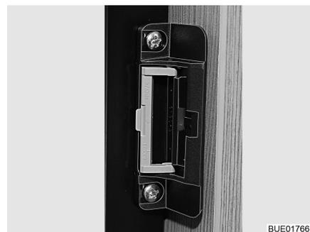
Fig. 65 Dispositivo di chiusura in posizione di ricircolo d'aria
