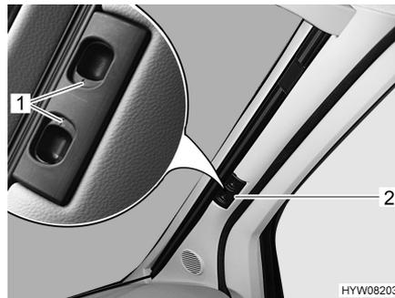
Fig. 8 Tendina oscurante pieghevole per il parabrezza
