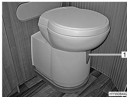
Bild 78 Thetford-Toilettenschüssel, schwenkbar
