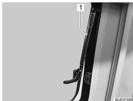
Bild 14 Ausstellfenster mit Automatik-Ausstellern, geöffnet
