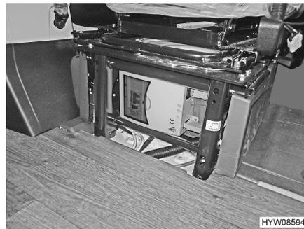
Bild 53 Einbauort 230-V-Sicherungskasten
