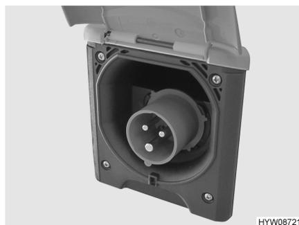
Fig. 48 Conexión de 230 V en el vehículo
