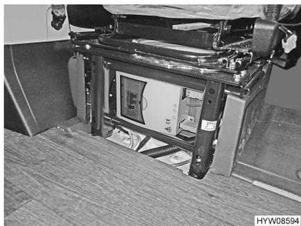
Fig. 53 Lugar de instalación de la caja de fusibles de 230 V
