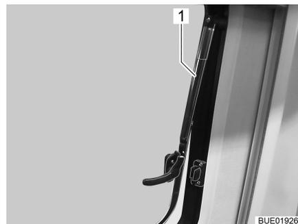
Fig. 14 Ventana abatible con soportes automáticos, abierta
