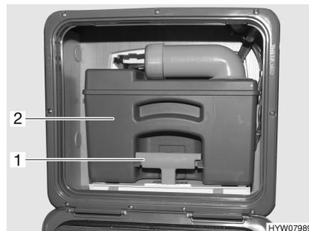
Fig. 81 Depósito de aguas fecales
