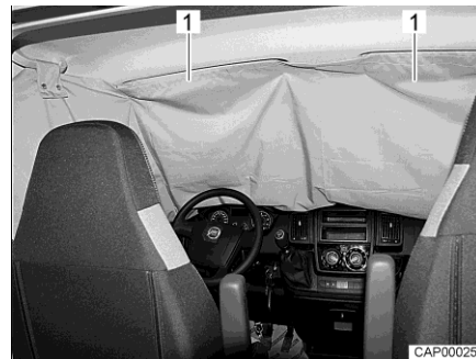
Afb. 22 Verduistering bestuurderscabine aan voorruit
