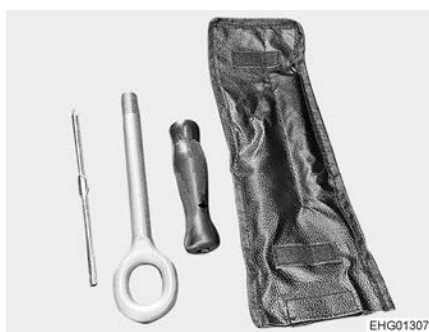
Bilde 222 Slepeøye og skrutrekker (basiskjøretøy Stellantis)
