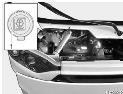
Bilde 17 Påfyllingsstuss (vindusspyler-væske)
