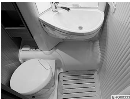
Bilde 201 Toalettsetet dreier mot veggen
