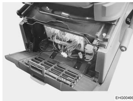
Bilde 151 Monteringssted for strømsentral (Stellantis), fig. lignende
