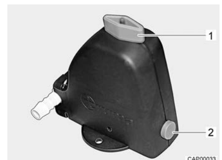
Bilde 195 Sikkerhets-/avtappingsventil åpnet
