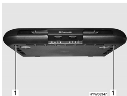
Bild 119 Untere Abdeckung abschrauben
