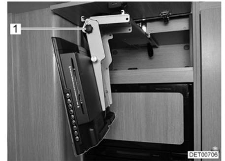
Fig. 46 Pantalla plana en posición de televisión
