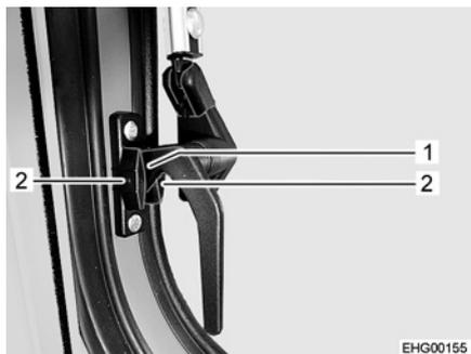
Fig. 27 Palanca de bloqueo de al lado (posición "Ventilación continua")
