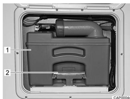
Fig. 118 Depósito de aguas fecales
