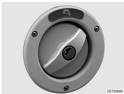
Fig. 100 Tapa de cierre para el tubo de llenado de agua potable
