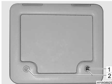
Bild 117 Lucka för latrintanken
