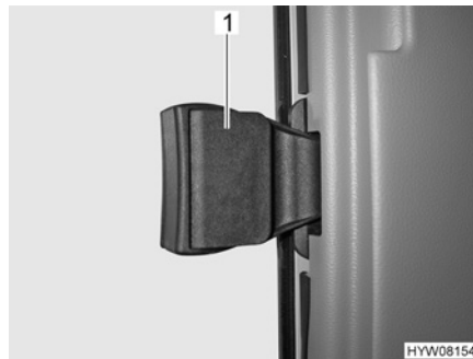
Bild 22 Skjutfönster utan lås
