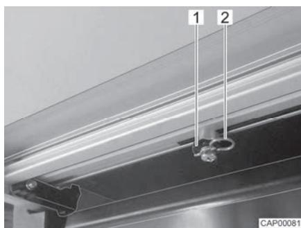
Fig. 85 Varilla de accionamiento (escalón de entrada)
