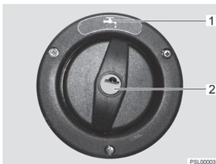
Fig. 71 Tapa de cierre para el tubo de llenado de agua potable
