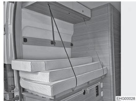
Fig. 36 Posición de transporte (somier extraíble)
