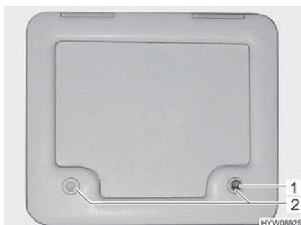
Fig. 83 Trampilla para el depósito de aguas fecales
