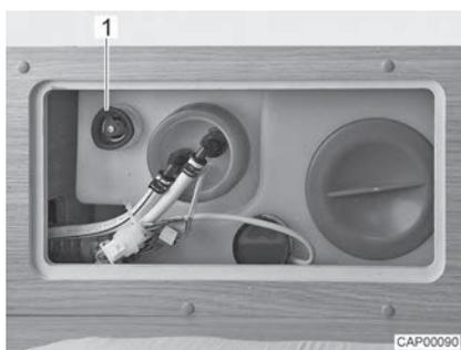
Fig. 74 Depósito de agua con tirador giratorio
