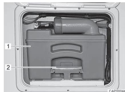
Fig. 84 Depósito de aguas fecales
