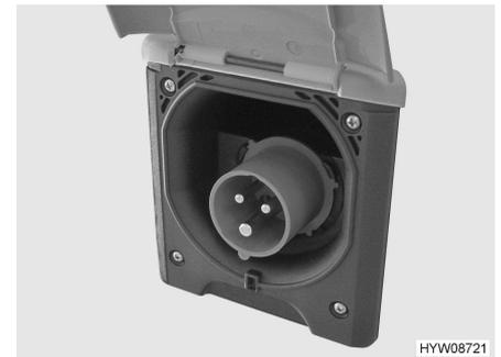
Fig. 71 Raccordement 230 V sur le véhicule (prise de courant CEE)
