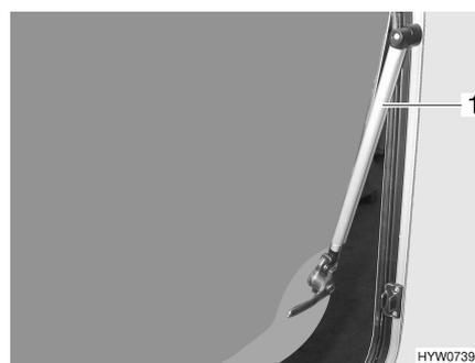
Fig. 22 Fenêtre projetante avec bras automatiques
