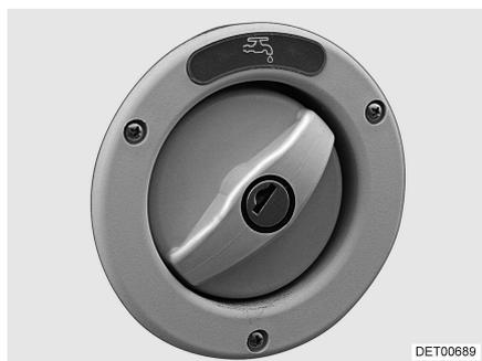
Fig. 96 Couvercle de fermeture pour bec de remplissage d'eau potable
