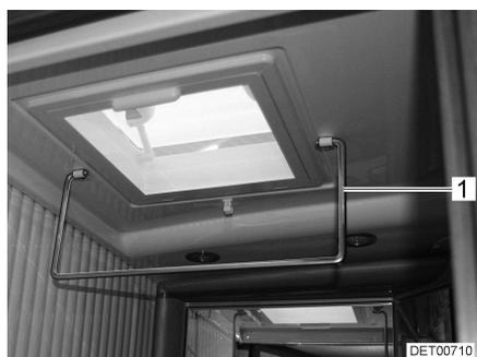
Fig. 106 Barre de séchage du linge
