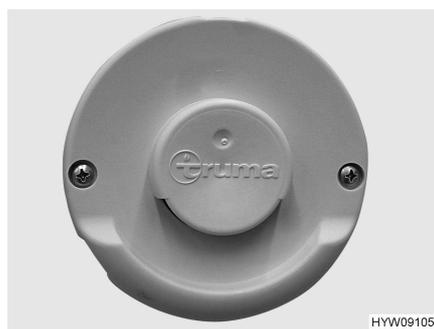
Fig. 85 Cheminée murale (chauffage à air chaud)
