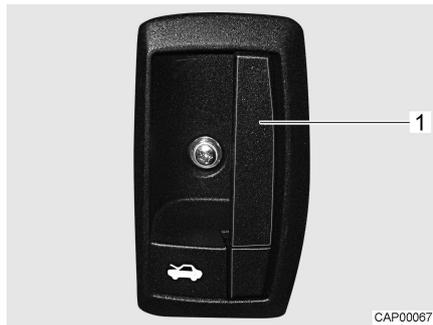
Fig. 5 Levier de déverrouillage (capot moteur)
