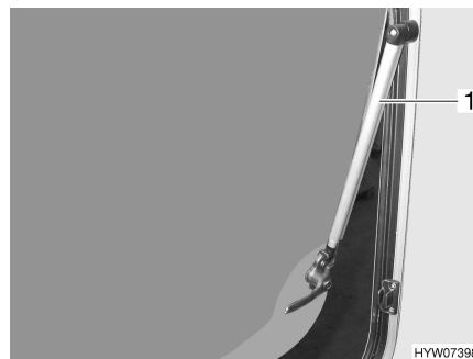
Bilde 22 Vindu som kan åpnes utover med armer med automatisk låsing
