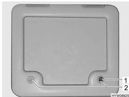
Bilde 113 Klaff for kloakktanken
