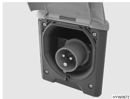
Bilde 71 230 V-tilkobling til kjøretøyet (CEE-stikkontakt)
