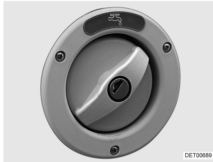
Kuva 96 Juomavesisäiliön täyttöaukon korkki
