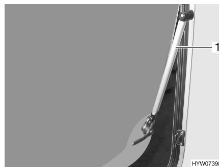
Kuva 22 Avattavat ikkunat, joissa on automaattipidikkeet
