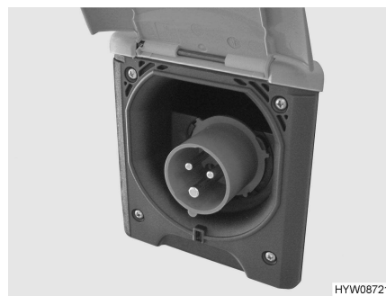
Kuva 71 230 V:n liitäntä ajoneuvolla (CEE-pistorasia)
